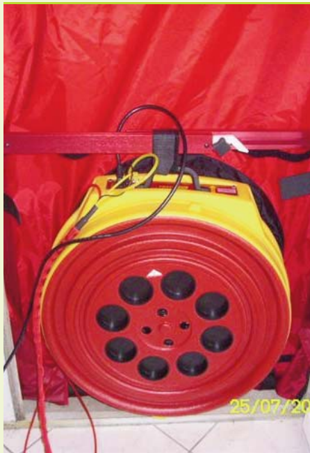
Ventilateur pour le test d'étanchéité à l'air
