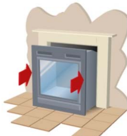
Insert encastrable (remplacement d'un foyer ouvert)
